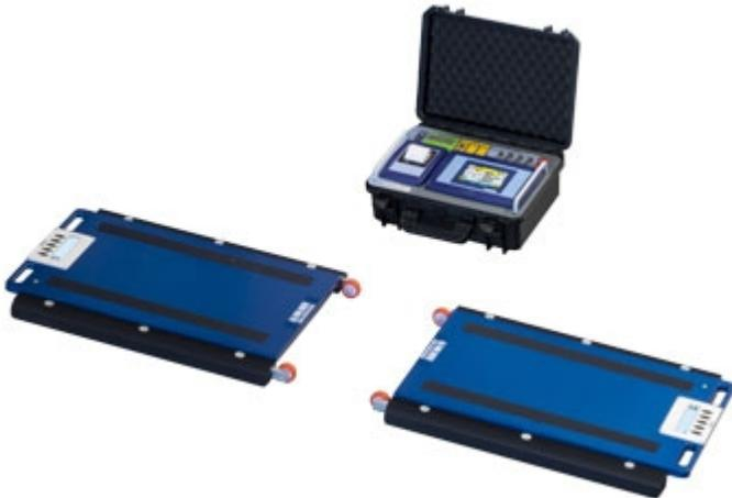
Il pèse les essieux du véhicule et calcule le poids total. Composé de deux plateformes portables de la série WWS et du terminal de pesage à écran tactile avec imprimante intégrée. Version sans fil.
